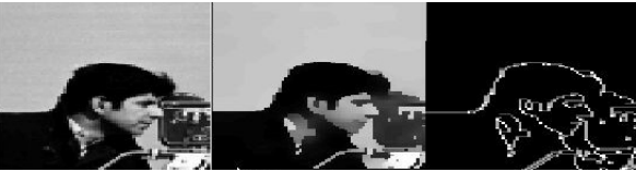
Figure 3 Mumford-Shah : de gauche à droite, original, résultat et bords
